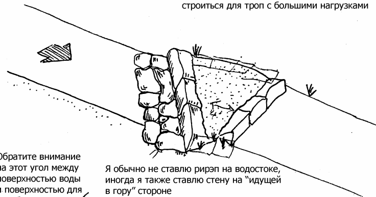
Водоотвод с подпоркой и с желобом рипрэп строится для троп с большими нагрузками
